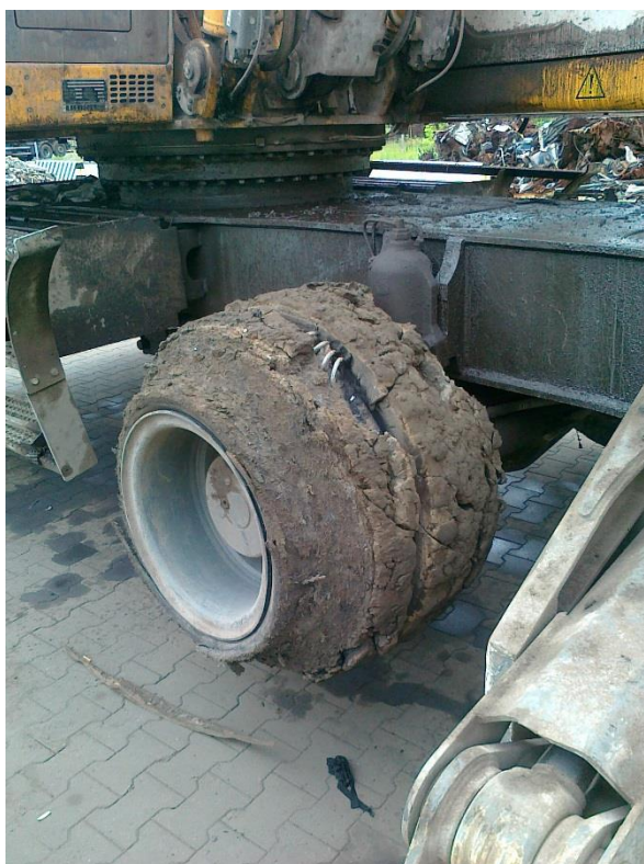
Rysunek 7. Ponadnormatywne zużycie koła jezdnego żurawia samojezdnego.
