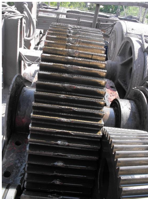
Rysunek 8. Ponadnormatywne zużycie koła zębatego przekładni mechanizmu podnoszenia.
