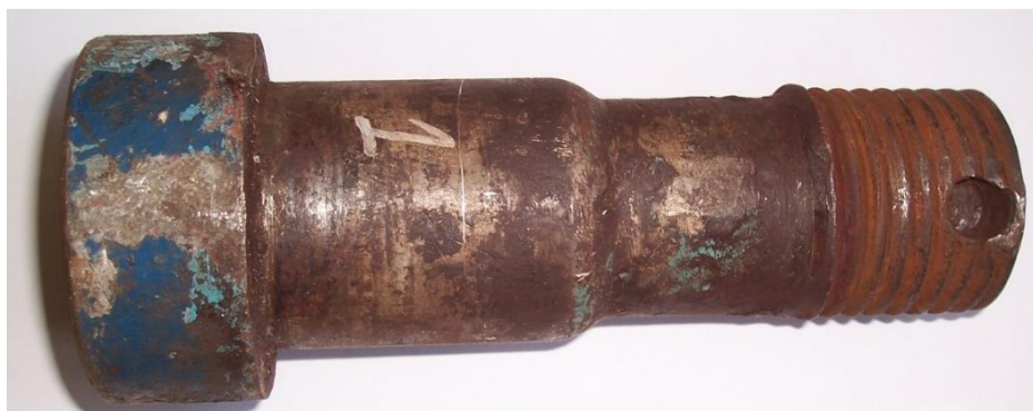
Rysunek 2. Śruba zawieszania wciągніка z zaawansowaną korozją gwintu.
