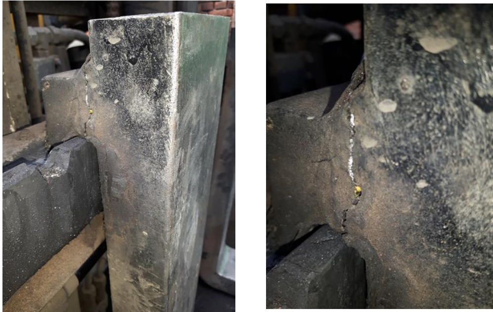
Rysunek 16. Pęknięcie widły wózka jezdniowego podnośnikowego.
